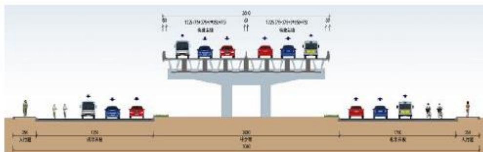
图 2.5.2-5 开创路北延高架段标准横断面图
